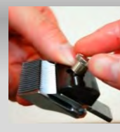
⑤調節ナットを締めます。締め具合は最後まで締めてからナットを1回転半くらい緩めるのが目安です。
