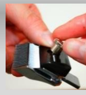
⑤調節ナットを締めます。 締め具合は最後まで締めてからナットを1回転半ぐらいいねるのが目安です。
